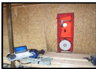
Installation du système de mesure sur la porte d'accès garage
